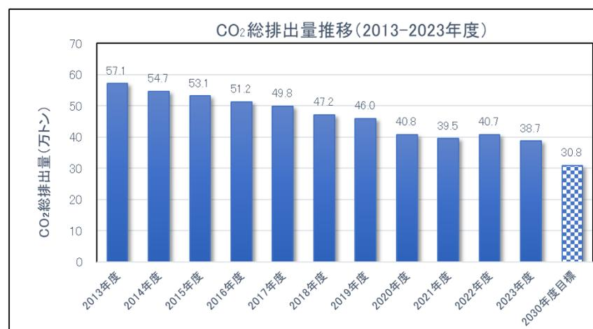
4. これまでの活動では、都市ガスへの燃料転換、新たな動力設備の導入(コージェネレーション、アンモニア冷凍機、高効率小型貫流ボイラーの導入等)、各製造工程での省エネルギー活動がCO<sub>2</sub>排出量削減に大きく貢献してきた。2023年の革新的技術開発として、排水処理における排水汚泥エネルギー転換(嫌気MBR)の導入などがあった。
